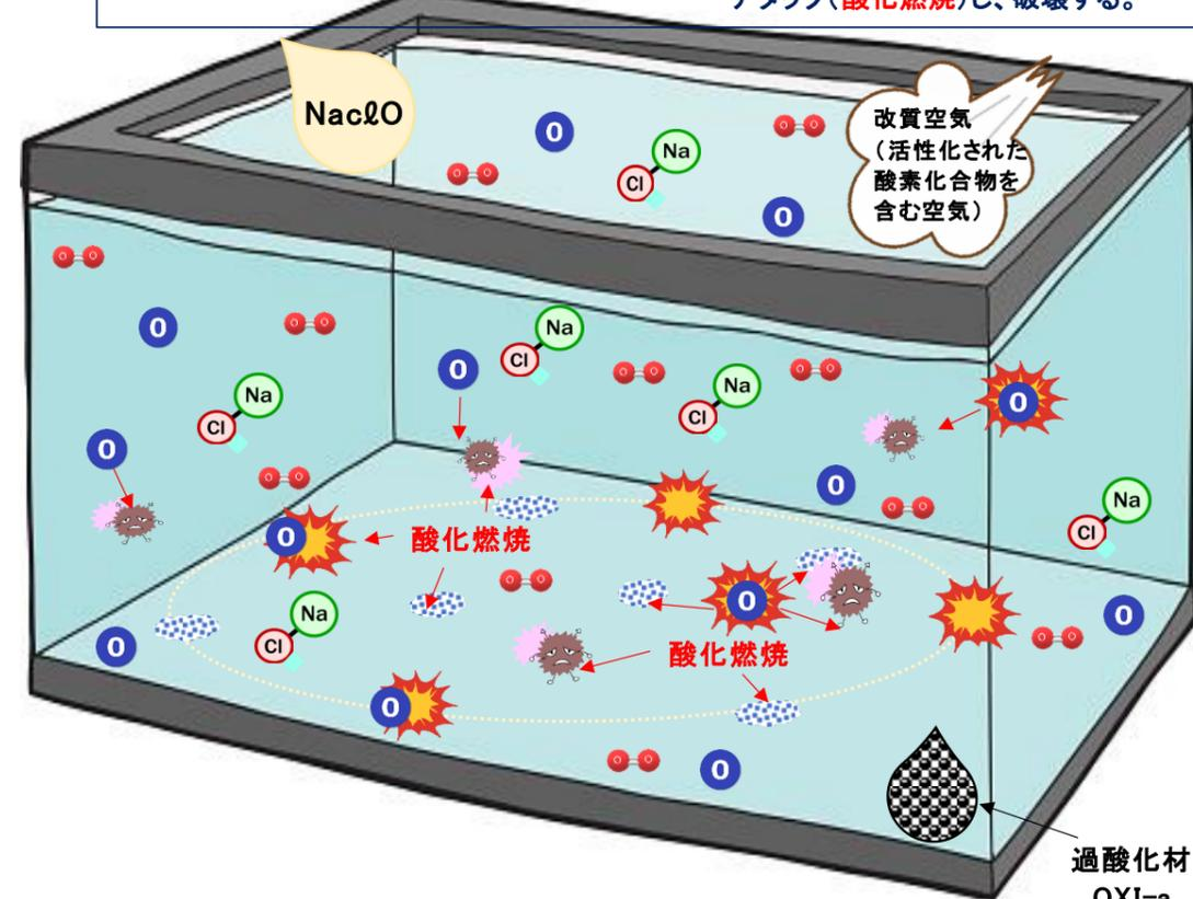
真未来システムから発生する改質空気及び過酸化材の酸化反応により、液中の次亜塩素酸ナトリウムは、NaClと、発生期の酸素(O)に分解される。
